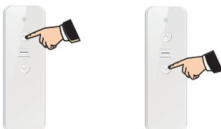
Vérifiez le sens de rotation du moteur en appuyant sur la touche **Montée** ou sur la touche **Descente**. Si le sens de rotation est bon, passez directement à l'étape 4, sinon suivez l'étape 3.
