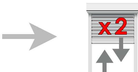
Le volet fait un va-et-vient au bout de 7 secondes.
