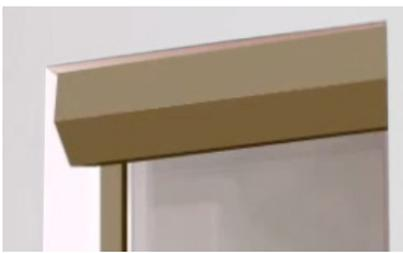
Pour une pose sous linteau présentez le volet au plus près de la fenêtre avec le coffre orienté vers l'extérieur.
