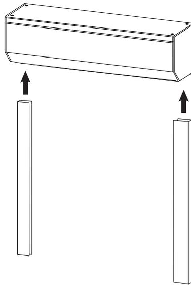
**4 -** Présentez votre volet à son emplacement final suivant le type de pose choisi et vérifiez la position des coulisses et du coffre à l'aide d'un niveau.
