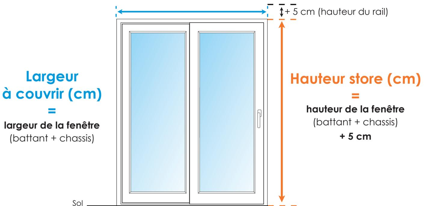
NB : tolérance de fabrication +/- 5mm
