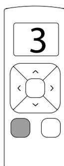
**19.4** Appuyez sur le bouton de programmation de la (nouvelle) télécommande pour coupler les stores à la (nouvelle) télécommande.
