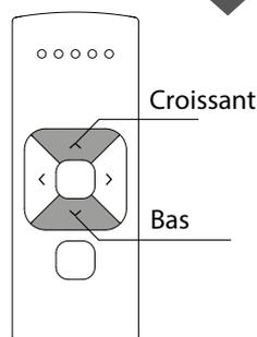
**4.1** Appuyez brièvement sur la touche bas pour vérifier si le store se déroule correctement. Si le store se soulève, le sens de rotation doit être modifié.
