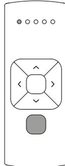
**18.2** Pour activer la sélection de canal simultanément, maintenez la touche de sélection de canal enfoncée et appuyez sur le bouton de couplage.
