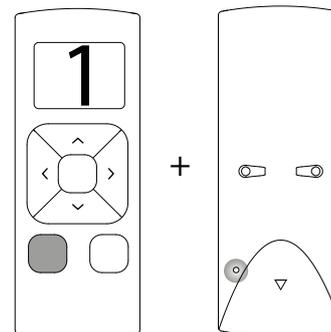
**19.3** Tous les stores de la chaîne sélectionnée commenceront à avancer, indiquant que le mode programme a été activé. Tous les stores peuvent être copiés sur un nouveau chaîne sur la même télécommande ou sur d'autres télécommandes. Sélectionnez un chaîne sur une (nouvelle) télécommande.
