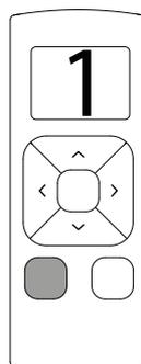
**19.2** Pour activer la sélection de chaîne simultanément, maintenez la touche de sélection de chaîne enfoncée et appuyez sur le bouton de couplage.
